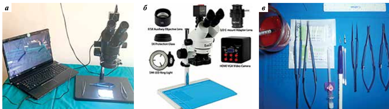
Рис. 1. Внешний вид микроскопа и инструментарий: а — микроскоп с подключенным компьютером; б — базовый набор микроскопа; в — инструменты, нитки и дополнительные материалы для проведения микрохирургического тренинга
