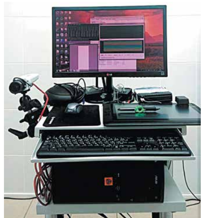
Рис. 1. Установка для проведения пассивного картирования функциональных зон коры головного мозга в условиях операционной
