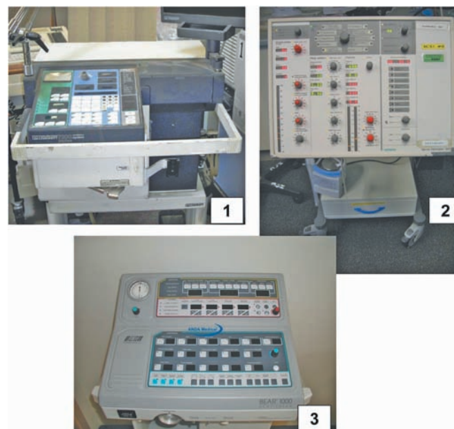
Рис. 16. Аппараты для искусственной вентиляции легких третьего поколения: Bennett 7200 (1), Servo 300 (2), Bear 1000 (3). Fig. 16. The third-generation ICU ventilators: Bennett 7200 (1), Servo 300 (2), Bear 1000 (3).
