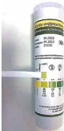
Рис. 2. Положительный результат теста на содержание глюкозы в назальном секрете. Сравнение окрашенных индикаторных полосок (БИОСКАН® – ГЛЮКОЗА, Россия) с цветовой шкалой
