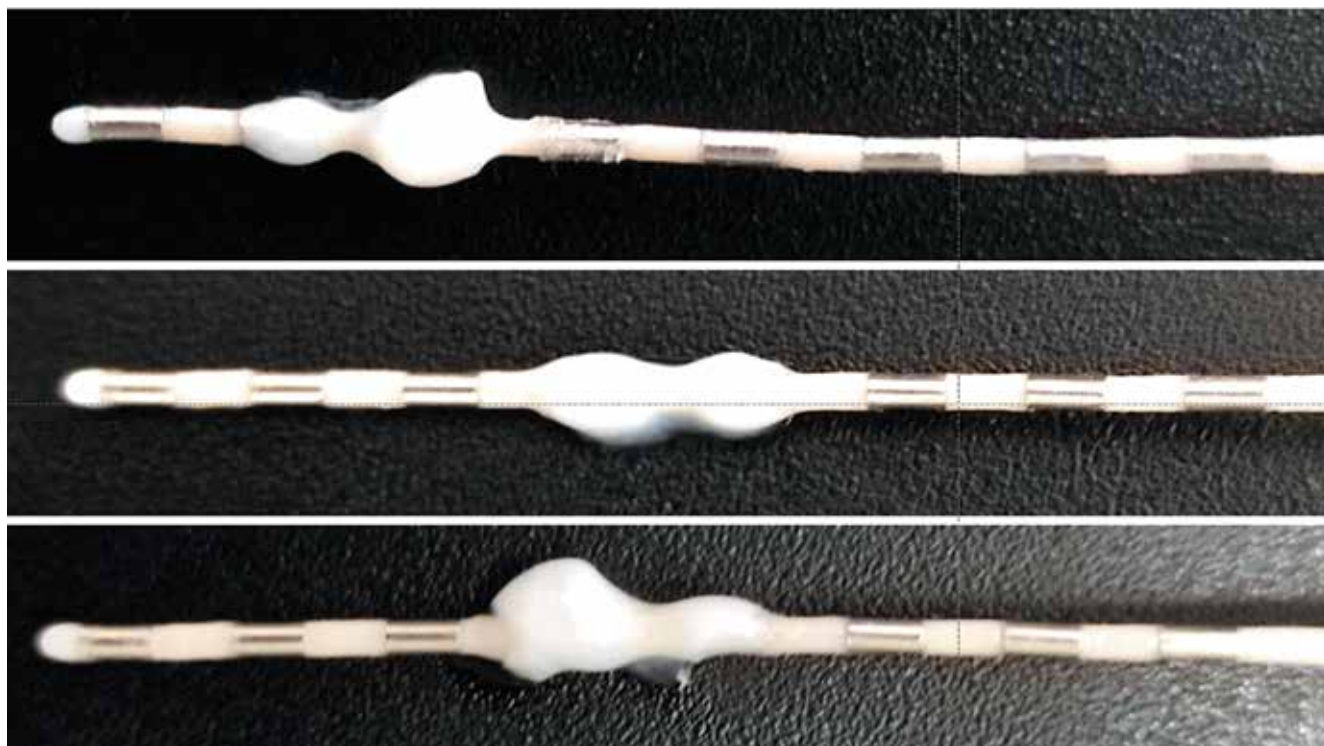
Рис. 4. Внешний вид электродов после выполнения радиочастотной термокоагуляции
